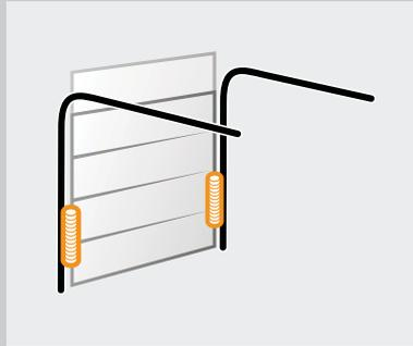
**BZ-Beschlag:** Zugfeder-Beschlag mit Zugfeder-Technik und flächenbündiger Blende
